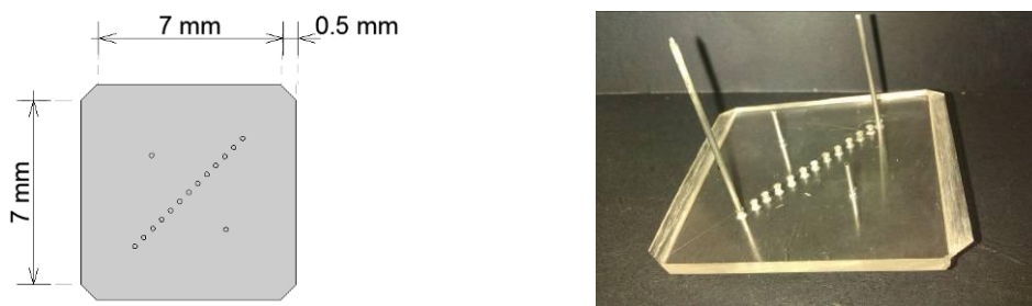
Figura 15. (a) Schiță a capacului electrozi; (b) Fotografie a capacului în care se văd doi electrozi
