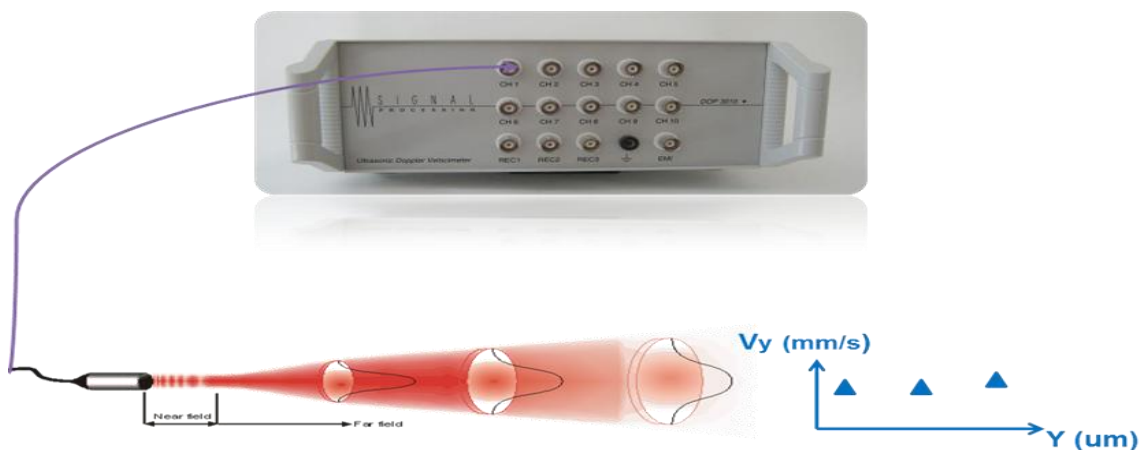
Figura 16. Volumele de măsură a proiecției vitezei de-a lungul pulsului de ultrasunete emis de către transducer
