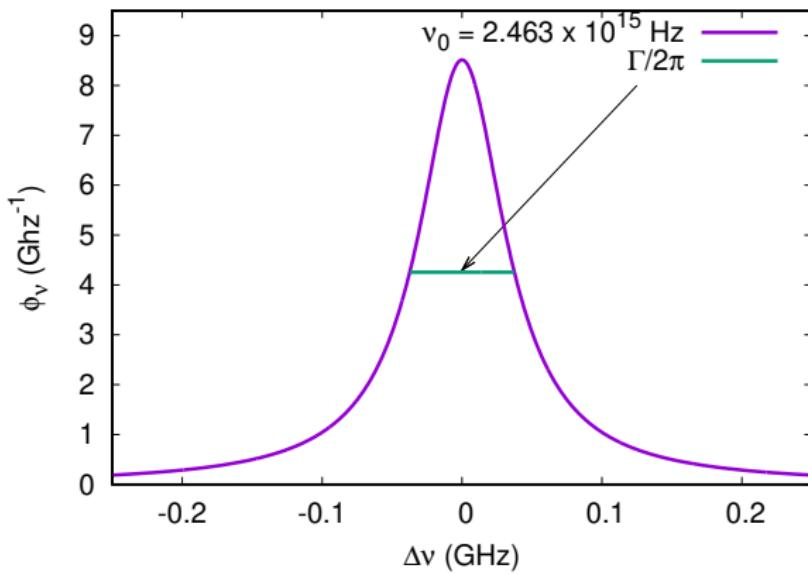
Profilul Lorentz  $\varphi_\nu$ : lărgimea naturală a liniei corespunzătoare tranzitiei  $L\alpha$  a hidrogenului ( $\nu_0 = 2,463 \times 10^{15} \text{ Hz}$ ), având lățimea întreagă  $\Gamma/2\pi \simeq 75 \text{ MHz}$ .
