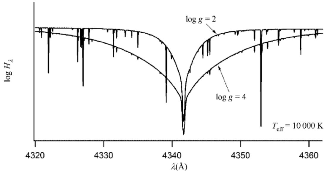
Lărgirea în atmosfera a două stele cu  $T_{\text{efectiv}} = 10.000 \text{ K}$  având  $\log g = 2$  ( $1 \text{ m/s}^2$ , stea supergigantă) și  $\log g = 4$  ( $100 \text{ m/s}^2$ , stea de pe secvența principală). Linia reprezentată corespunde tranzitiei Balmer- $\gamma$  ( $n = 2 \rightarrow n = 5$ ). Liniile vizibile în spectrul stelei cu  $g = 2$  (corespunzătoare metalelor) dispar la  $g = 4$ .
