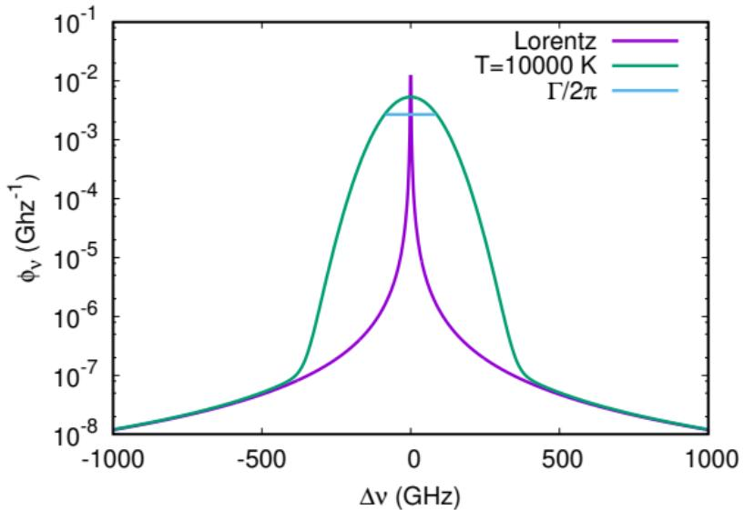
Lărgirea Doppler a liniei corespunzătoare tranziției Ly- $\alpha$  a hidrogenului ( $\nu_0 = 2,44 \times 10^{15} \text{ Hz}$ ) datorată agitației termice la  $T = 10000 \text{ K}$ . Lățimea întreagă este în acest caz  $\Gamma/2\pi \simeq 175 \text{ GHz}$  (comparat cu  $\Gamma/2\pi \simeq 0.095 \text{ GHz}$  aferentă profilului Lorentz).
