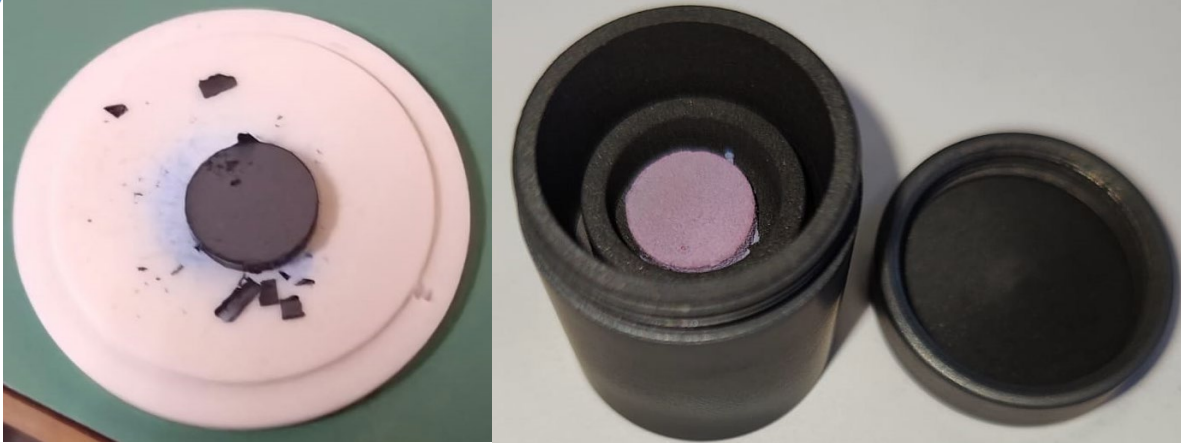
Figura 10. (a) Pastila de HEO-1 anterior incalzirii in instalatie (b) Pastila de HEO-1 ulterior incalzirii in instalatie la o temperatura de 1703°C indicand un schimb de culoare si rugozitate.
